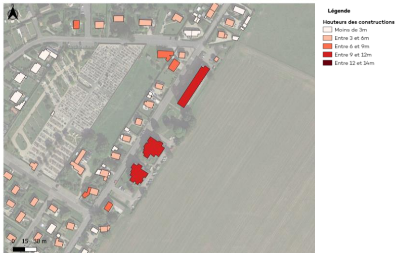
Hauteurs d'habitats collectifs mesurées à l'égout du toit à Saint-Nicolas-d'Alermont (Réalisation : Géostudio)
